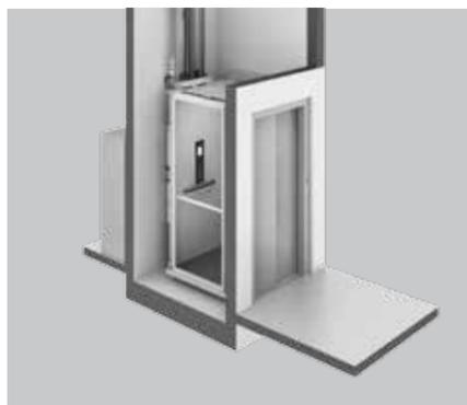
H200 cabina con porte scorrevoli è una cabina completamente chiusa dotata di porte telescopiche su ogni accesso. Gli accessi sono protetti da fotocellule o da barriere fotoelettriche opzionali a tutta altezza. Le porte di cabina possono essere anche panoramiche, a scorrimento laterale in 2 pannelli o ad apertura centrale in 4 pannelli. Disponibile in lamiera plastificata o verniciata ed anche in acciaio inossidabile.
